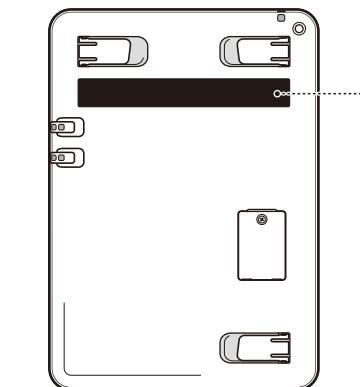
背面にあるマグネットで金属面に貼り付けられます。
