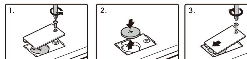
1. プラスドライバーでネジをはずし、ネジ側から電池蓋をはずします。
